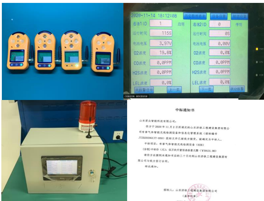
图 2-13 救援联动式桩基井有害气体检测仪
